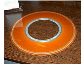
Disque dur du Ramac 305 50 disques de 60 cm, 5 Mo, 8,8 ko/s Source : wikipedia.fr
