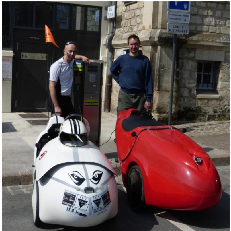
21 Vélocycle en charge sur une prise traditionnelle (16 A, 220 V), 1 heure de recharge à 20 A ayant une décharge à 80 %
