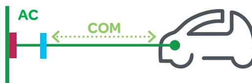
Mode 2 : dispositif de protection incorporé au câble
