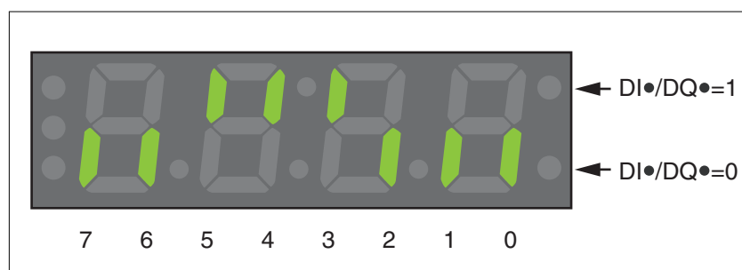
Illustration 42: Afficher l'IHM intégrée, les états du signal des entrées (DI•) et des sorties (DQ•) logiques
