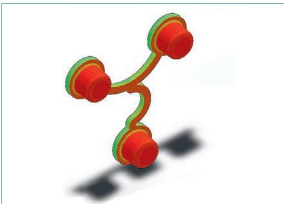
**4** L'analyse d'épaisseur permet de repérer avant toute simulation les zones à retassures potentielles
