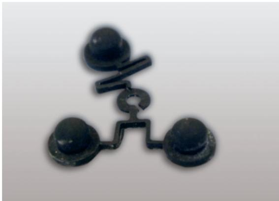
**11** Un tripode industriel défaillant : la ligne de soudure est de mauvaise qualité
