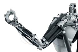
Commandés par une mécatronique des plus modernes, réglés par la piézotechnique de Festo, 30 muscles pneumatiques déplacent le squelette du bras robotisé à la manière du modèle humain.
