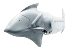
La construction, la forme et la cinématique de l'Airacuda sont inspirées de son modèle biologique. Quatre muscles pneumatiques et la structure à Fin Ray Effect assurent le mouvement ondulatoire et la direction souple de la queue.
