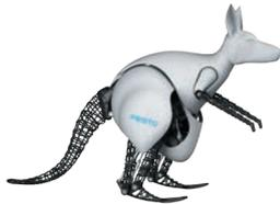
Comme son modèle naturel, le kangourou artificiel récupère l'énergie au bond, l'emmagasine et la réutilise efficacement au prochain bond. Sa stabilité est assurée par une technique de commande et de régulation précise. La combinaison intelligente d'entraînements pneumatique et électrique permet un comportement unique au bond. Le système est commandé par des gestes.
