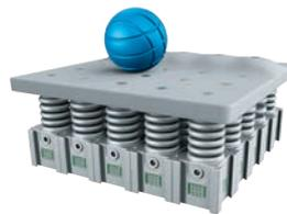
Le convoyeur pneumatique peut transporter des objets et en même temps les trier. De nombreux modules à soufflet déforment la surface de sorte que l'ondulation qui en résulte transporte les objets à destination. Les divers modules s'emboîtent à volonté et se configurent tout seuls. Cela permet de mettre le système en service rapidement et sans programmation, dans les configurations les plus diverses. L'intégration de la fonction de tri rend superflue une unité de manipulation supplémentaire.
