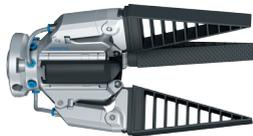
Une maîtrise parfaite : comme la main humaine, le MultiChoiceGripper peut combiner différents types de saisie. Ses doigts peuvent prendre tellement de formes qu'ils sont en mesure d'opter pour une saisie parallèle ou centrale – sans aucune transformation. De plus, les doigts à structure Fin Ray s'adaptent aux formes les plus diverses.
