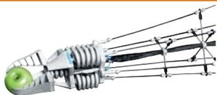
Grâce à sa pince adaptative et à sa construction légère et souple, la deuxième génération de Bionic Tripods est destinée aux travaux de manipulation d'objets sensibles à la pression et de différents contours et dimensions. La cinématique horizontale du tripode est orientable dans tous les sens jusqu'à 90 degrés, alors que le prédécesseur (en suspension) et le successeur (en position verticale, saisie tête en bas) sont orientés verticalement.
