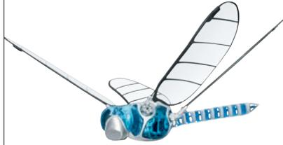
Avec le BionicOpter, Festo a reproduit techniquement les propriétés complexes du vol de la libellule. L'objet volant ultraléger peut se déplacer dans tous les sens, voler sur place et planer sans battre des ailes, un comportement rendu possible grâce à la construction légère et l'intégration des fonctions. La cinématique intelligente compense les vibrations du vol, le contrôle permanent en temps réel des données de vol garantit un vol stable.
