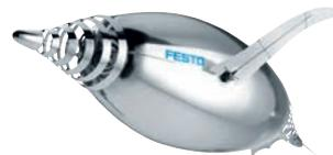
La mobilité des objets en vol collectif est très proche de celle de leur modèle biologique maritime : grâce à la structure 3D à Fin Ray Effect, leurs parties arrière et avant sont maniables. La construction d'ailes à torsion passive permet d'obtenir une poussée vers l'avant ou l'arrière. Dans un espace aérien défini par ultrasons, les AirPenguins peuvent même voler dans l'air en toute liberté et autonomie.
