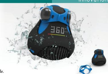
Légère, de la taille d'un œuf, ressemblant à un drôle de poisson, la 360cam est équipée de trois objectifs fisheye (185°) de 8 mégapixels dont les champs de vision se recoupent, ce qui permet une capture sur 360° horizontalement et 300° verticalement.
