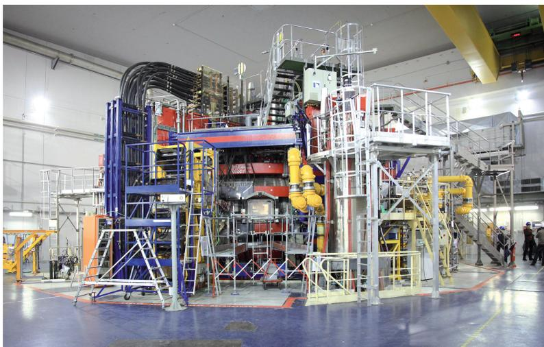
■ Le tokamak Tore-Supra du CEA est utilisé pour tester des composants qui font face au plasma
