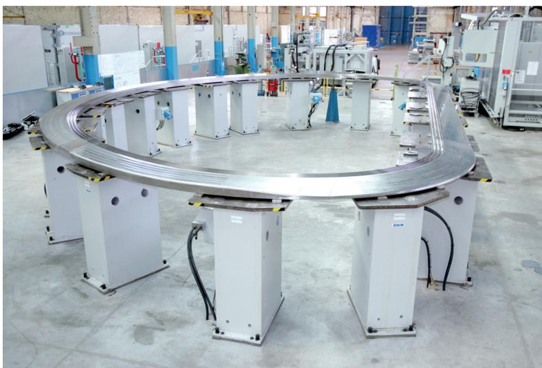
■ À La Seyne-sur-Mer, Cnim a mis au point des technologies de production innovantes pour fabriquer des plaques radiales pour les aimants supraconducteurs
