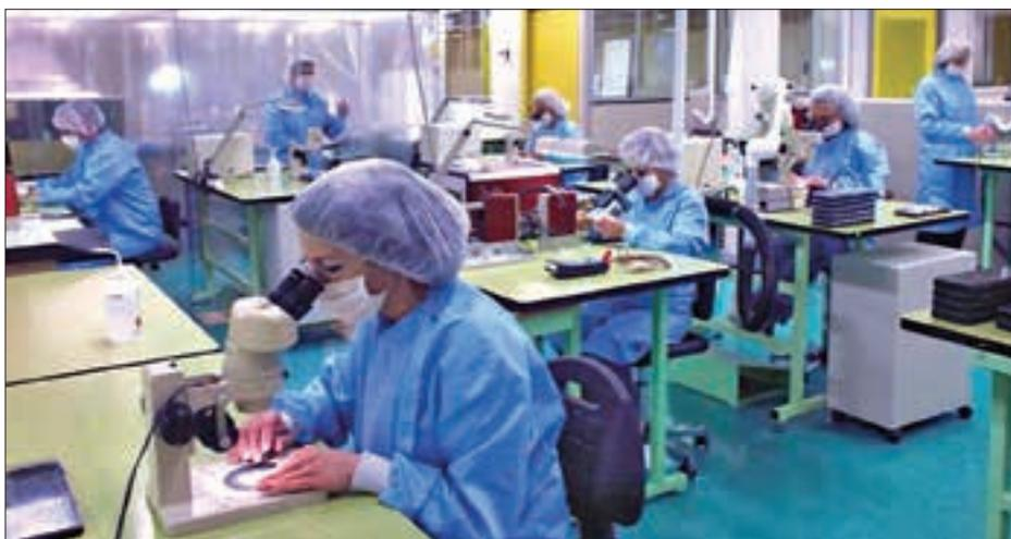
**Les dispositifs médicaux sont fabriqués dans deux salles propres équipées de plafonds laminaires classe ISO 5 et d'outillages spécifiques.** Source : Dixi Microtechniques
