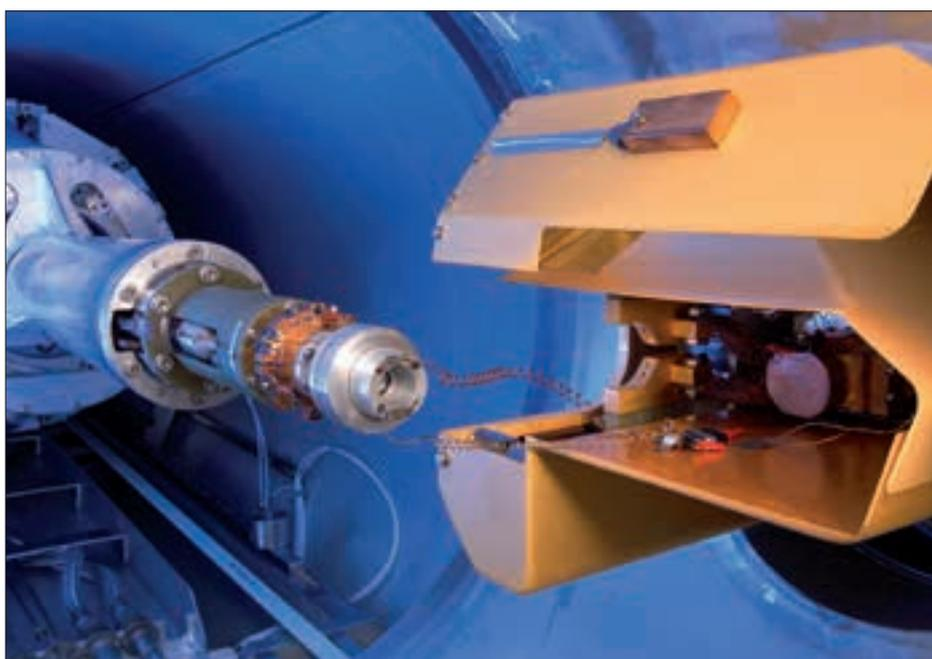
**Conçu par Symetrie cet hexapode porte-cible permet de régler avec une précision micrométrique la position de la cible au centre de la chambre d'expériences.** Source : artechnique.fr
