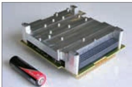
**Émetteur en bande X pour CubeSat et NanoSatellites capable de transmettre jusqu'à 13,3 Go par passage avec une station disposant d'une antenne de 5 m de diamètre.**
