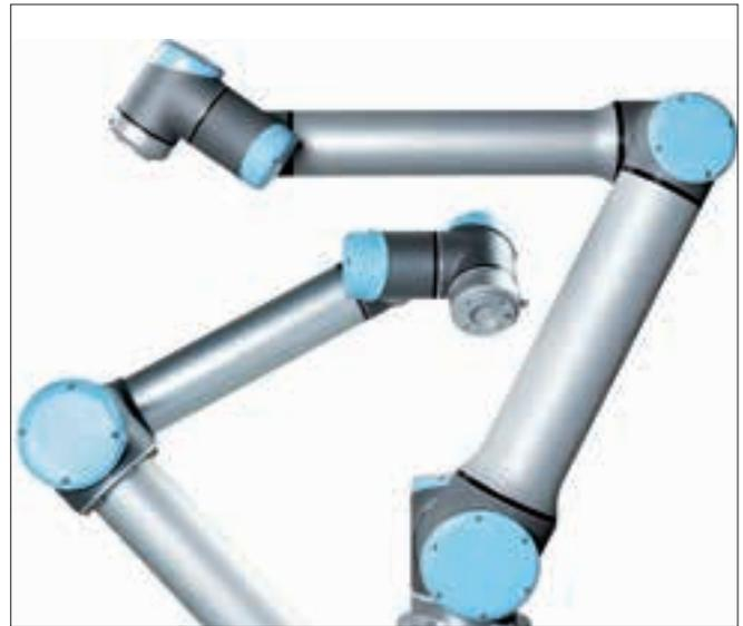
**Le démonstrateur proposé par le Cetim se compose de deux bras Universal Robot qui se programment par enregistrement des déplacements effectués manuellement.** Source : Cetim
