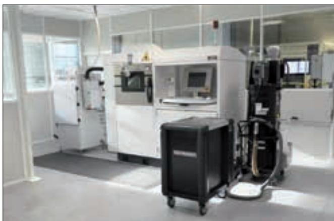
**La machine Eosint M280 du constructeur allemand EOS qui met en œuvre le procédé de fusion sélective laser (SLM) est déjà en service et a été qualifiée pour la production en série à l'usine Turbomeca de Bordes.** Source : Turbomeca
