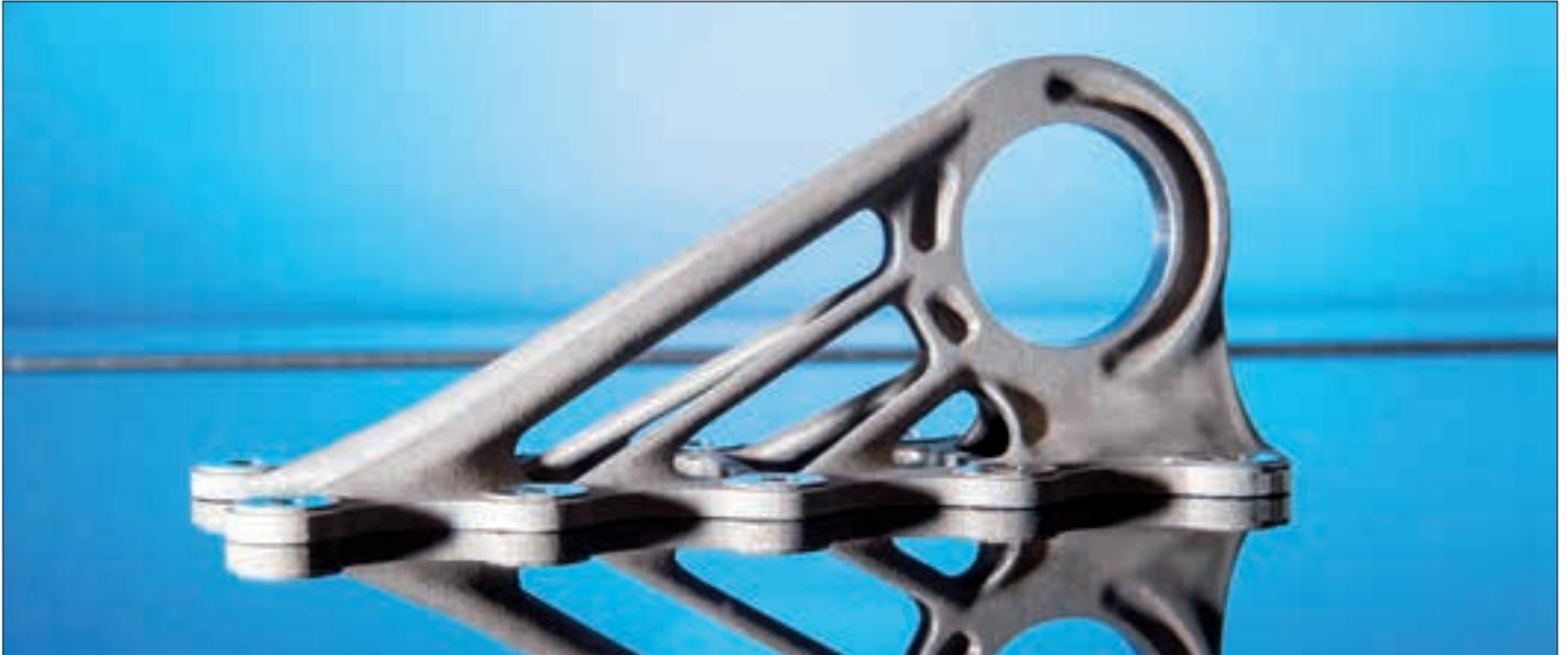
Chez Airbus l'utilisation d'une machine Concept Laser pour la fabrication additive d'un connecteur de l'A350XWB a permis des économies sensibles par rapport au fraisage ou à la fonderie : la quantité de déchets est passée de 95% à 5% et le poids a été réduit de 30%. Source : Concept Laser
