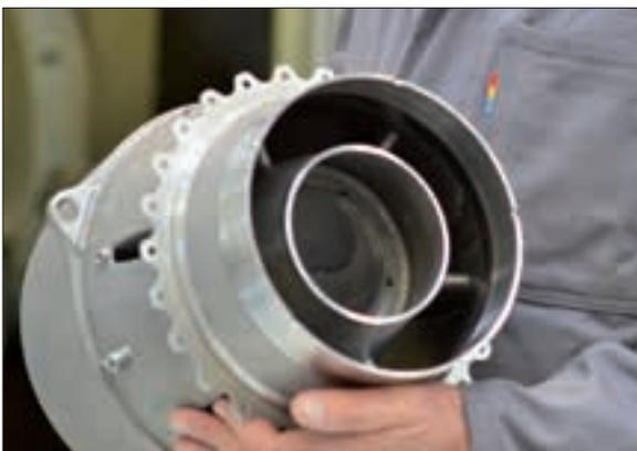
**Cartier tuyère réalisé par fusion laser chez Poly-Shape pour un fabricant de moteurs aéronautiques.** Source : Poly-Shape
