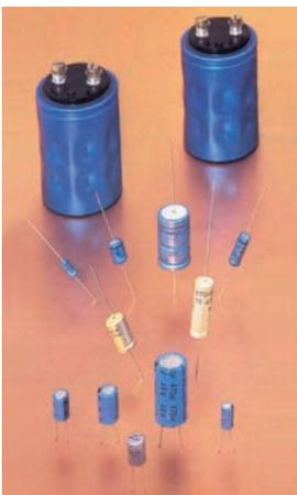
**24 Des condensateurs électrolytiques à électrodes d'aluminium**
