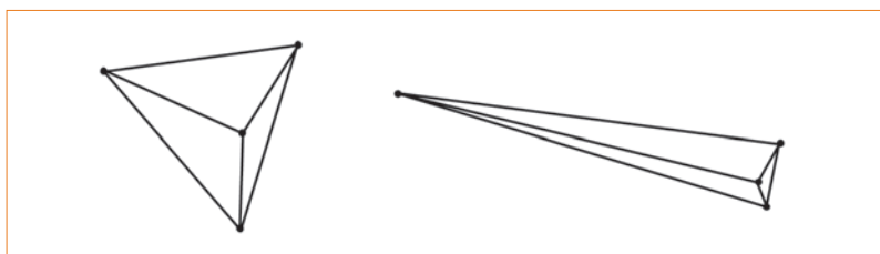
10 À gauche, élément à l'élongement idéal (proche de 1); à droite, élément à l'élongement important
