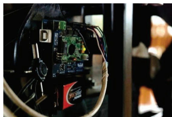
10 La nouvelle carte à relais statiques associée à une pile de 9 V
