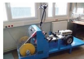
**L'E-Bikeboard, équipé de son banc de mesure, sur son banc de charge**
