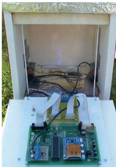
4 Vue intérieure de la nacelle avec l'enregistreur numérique de données
