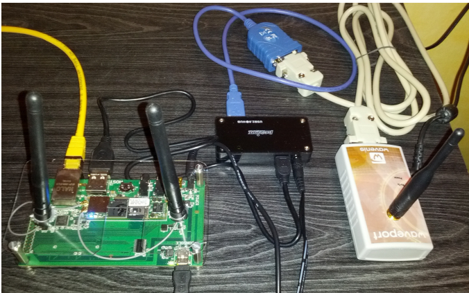
Fig. 1: La plateforme Linux embarqué Gumstix utilisée pour le test
