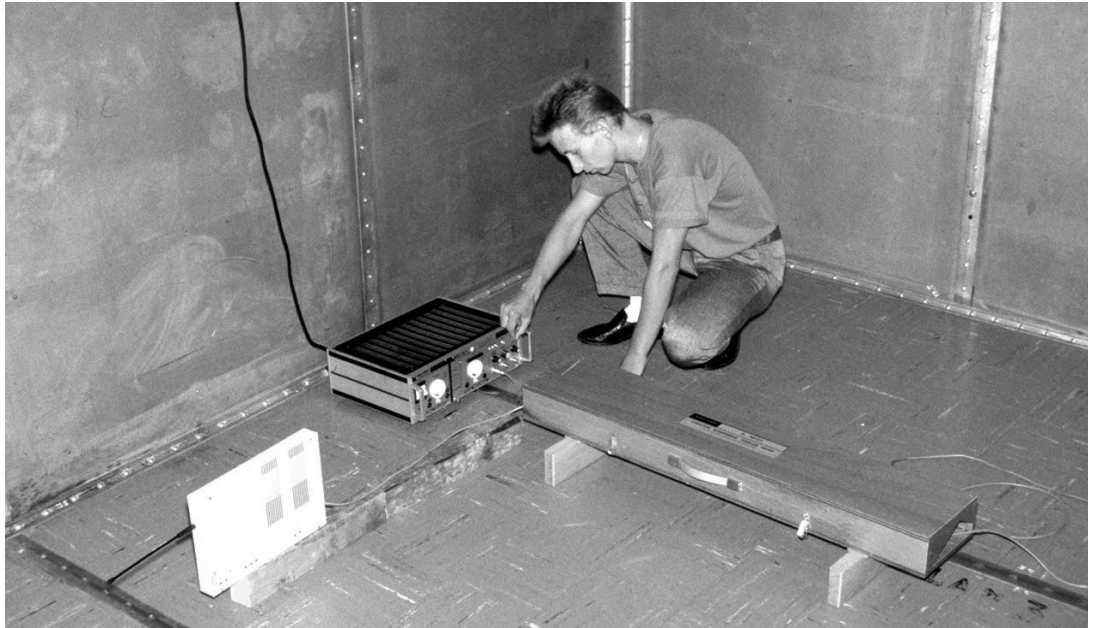
Fig. 28 : mesure de l'immunité aux transitoires rapides d'une centrale Isis (test 61000-4-4) dans une cage de Faraday. Sur cette photo sont visibles : le générateur de perturbation manipulé par l'opérateur, la valise en bois contenant la pince de couplage et la centrale Isis (à gauche) raccordée au réseau Batibus.
