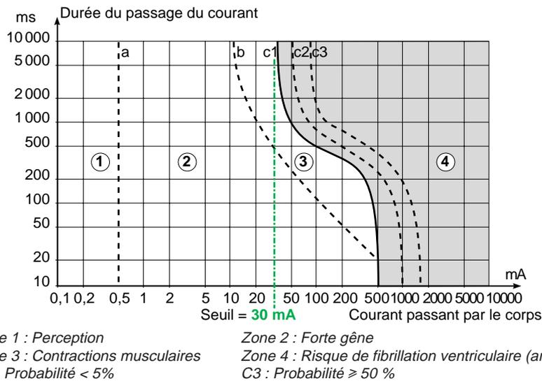
**Fig. 1** : zones temps/courant des effets du courant alternatif (15 Hz à 100 Hz) sur les personnes selon la norme CEI 60479-1.
