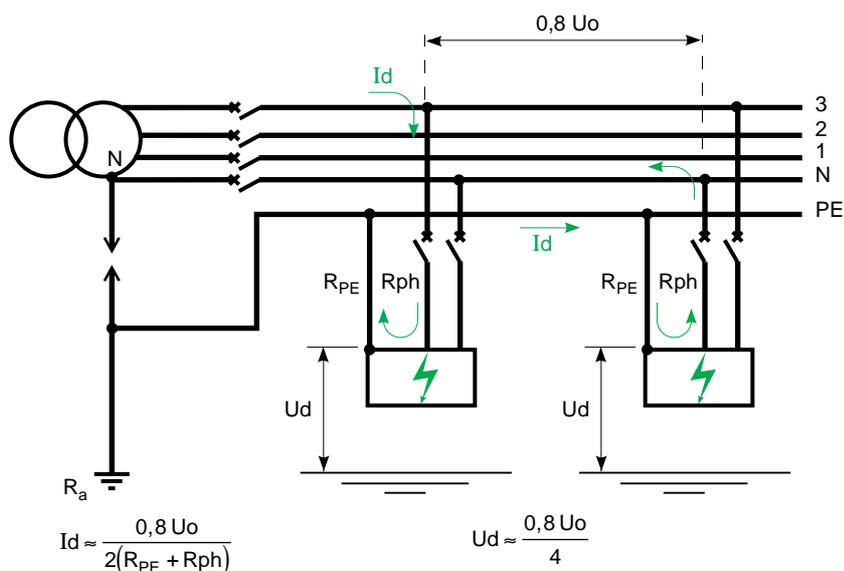
**Fig. 13** : courant de 2<sup>ème</sup> défaut en schéma IT (neutre distribué) et départs concernés de même section et même longueur.
