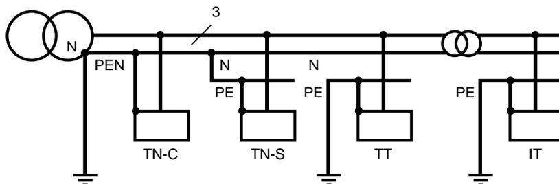
**Fig. 6 :** exemple de coexistence entre les divers SLT.
