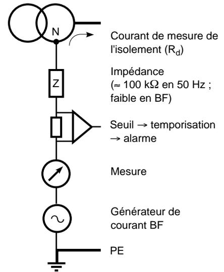
**Fig. 25** : schéma fonctionnel d'un contrôleur permanent d'isolement (CPI).
