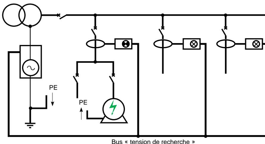
Le passage dans les conducteurs du courant de recherche est détecté par des capteurs magnétiques (tores). Chaque récepteur qui comporte un amplificateur sélectif (calé sur la fréquence et la phase du courant de recherche) calcule la résistance et la capacité du circuit (avec la tension et la phase dont il a la référence par un bus) et signale la présence du défaut.
