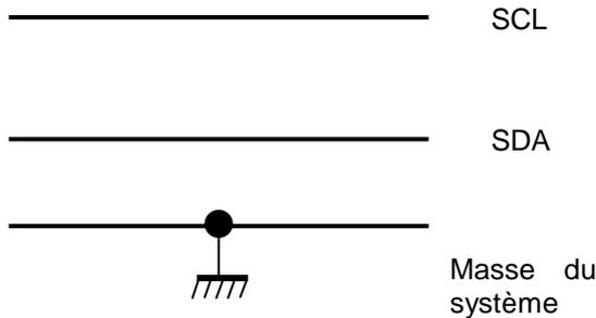
**SCL** (Serial CLock) : horloge de cadencement de la communication.
