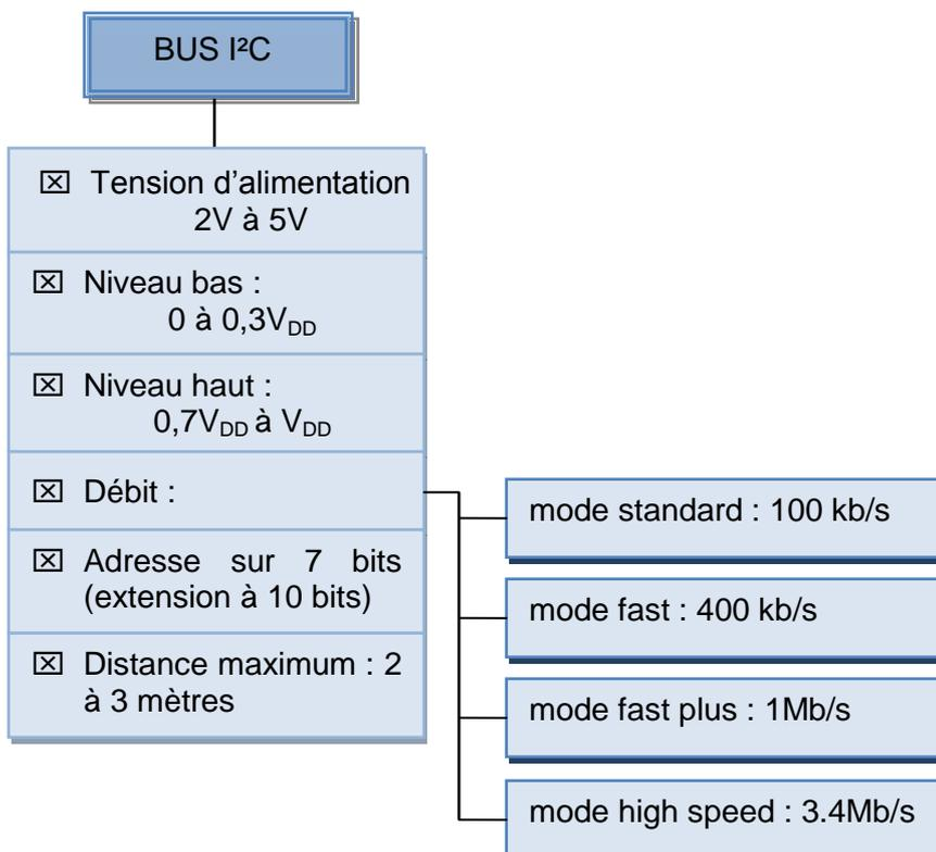
Il est possible d'utiliser les circuits alimentés par des tensions différentes dans un même montage. Il faut prendre alors des précautions (voir <http://www.i2c-bus.org/>).
