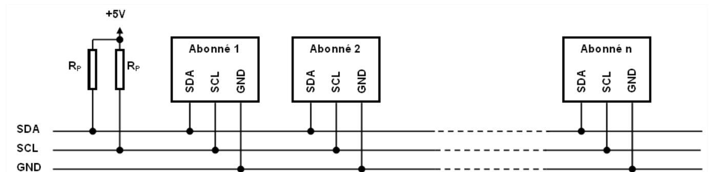
La charge capacitive maximum des lignes est de 400 pF. Cela limite le nombre d'abonnés pouvant être connectés au bus I<sup>2</sup>C. Cela limite aussi la longueur de la liaison (piste et/ou câble).
