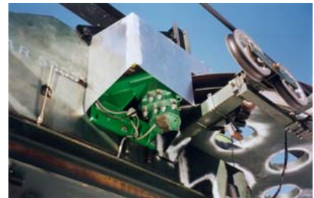
Poulie-câble d'un télésiège débrayable (Valmorel - France) Equipé de 2xSH15 pinces SIME-Stromag en 1999
