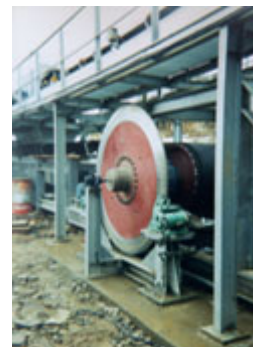
Une application CRD® (Espagne) avec des freins type TH9
