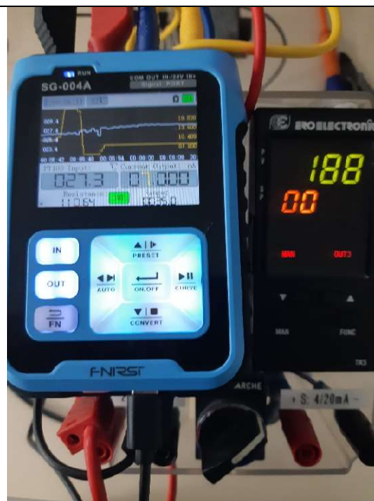
fig 24. Générateur de signal multifonction FNIRSI® SG-004A, input and output
