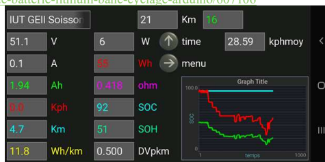
fig 13. Instrumentation open source sur ESP32 avec communication Bluetooth
