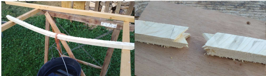
Fig. 8 : mise en charge d'un échantillon sur un banc « low-tech » mais néanmoins efficace (gauche) et rupture d'un échantillon avec veines à 45° (droite)
