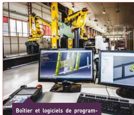
Boîtier et logiciels de programmation pour CN et robots Fanuc.
