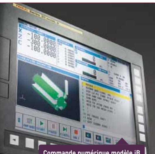
Commande numérique modèle iB de Fanuc.
