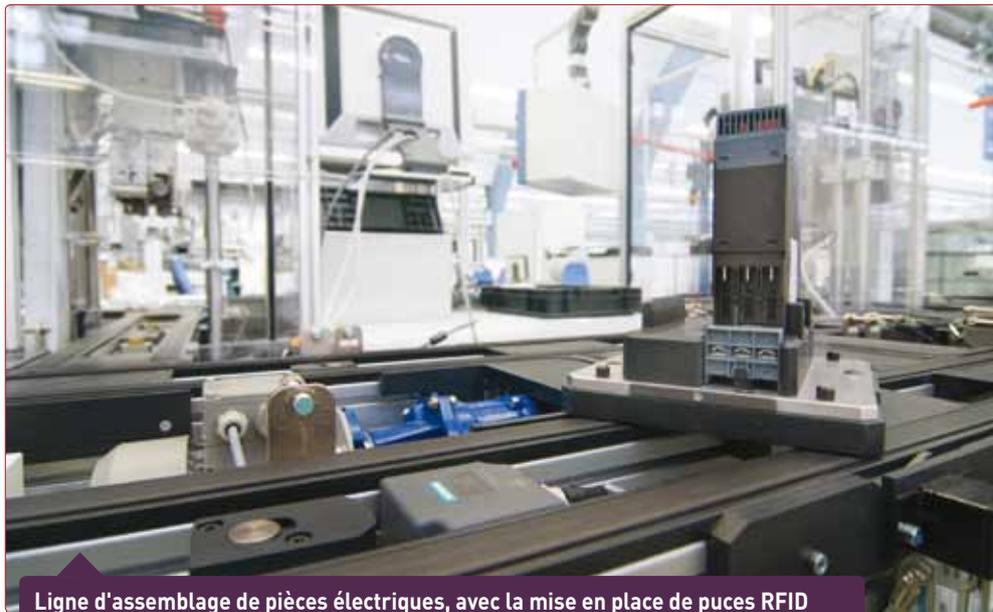
Ligne d'assemblage de pièces électriques, avec la mise en place de puces RFID sur les palettes afin de suivre la production de bout en bout.
