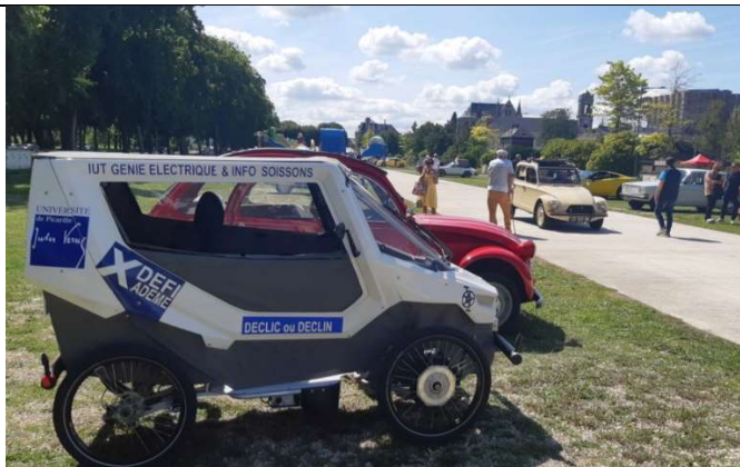
SOREAN QBX 25Wh/km@35km/h 1% dénivelé positif, 140kg
