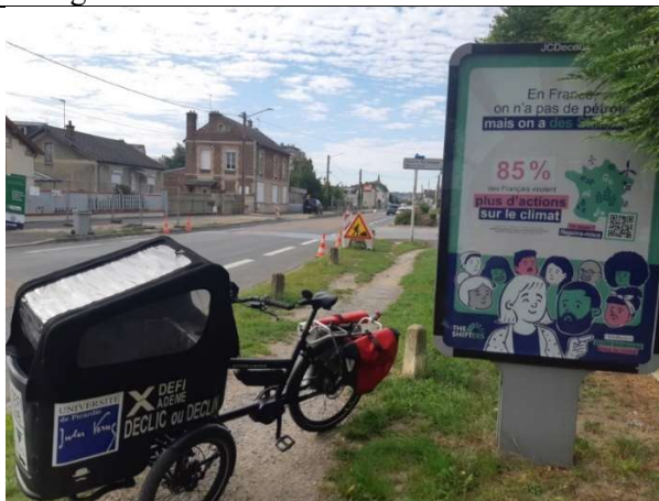
Tricycle cargo pendulaire 7.5Wh/km@20km/h 1% dénivelé positif, 50kg
