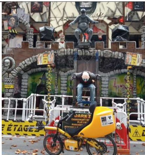
Velocouché AZUB 6 10Wh/km@35km/h 1% dénivelé positif, 35kg
