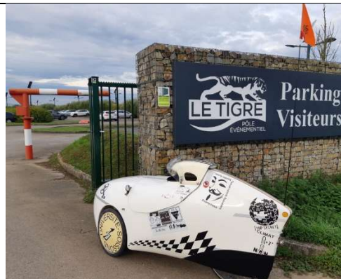
Velomobile leiba 10Wh/km @45km/h 1% dénivelé+ 50kg
