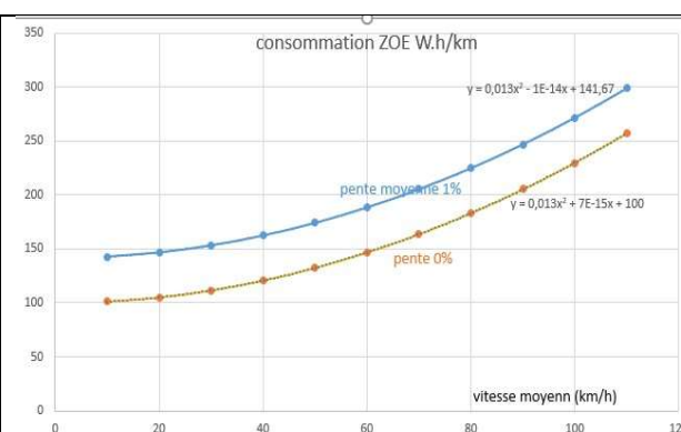
fig 7. Consommation d'une ZOE électrique en fonction de la vitesse
