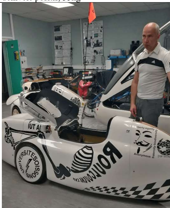
Velomobile WAW 7Wh/km @45km/h 1% dénivelé+, 45kg
