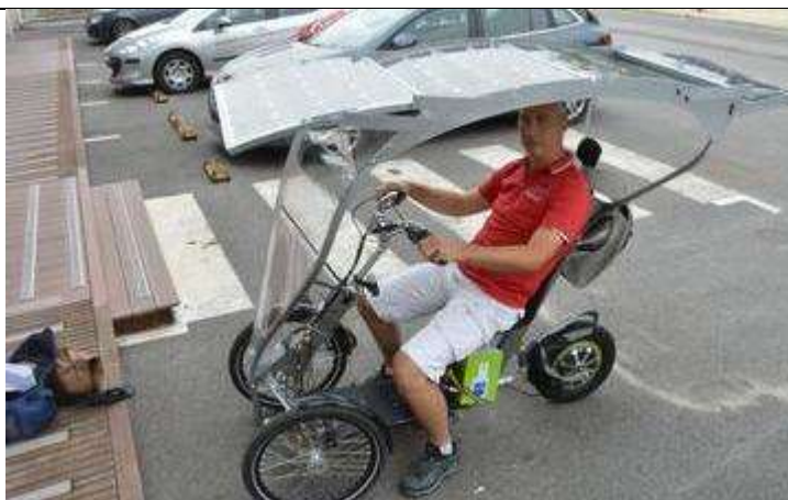
Tricycle pendulaire solaire 15Wh/km@35km/h 1% dénivelé positif, 50kg.
