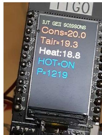
fig 22. Microcontrôleur vendu avec afficheur et module Bluetooth et wifi
