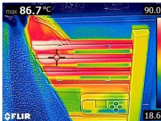
fig 11. Température max de radiateur sèche serviette à une température ambiante de 20°C
