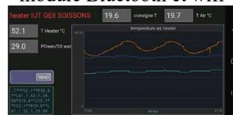
fig 23. Supervision de la température du radiateur, de la température en fonction du temps sur smartphone
