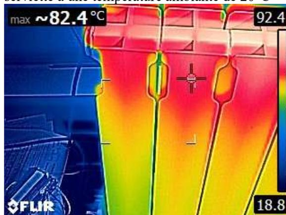
fig 12. Température max de radiateur inertiel
