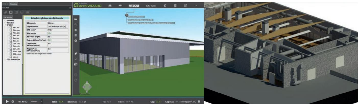
3 Validation RT2012 d'une salle de sport avant implantation des équipements effectuée par des étudiants de BTS FED 1<sup>re</sup> et 2<sup>e</sup> année (Graitec Archiwizard et Autodesk Revit)
