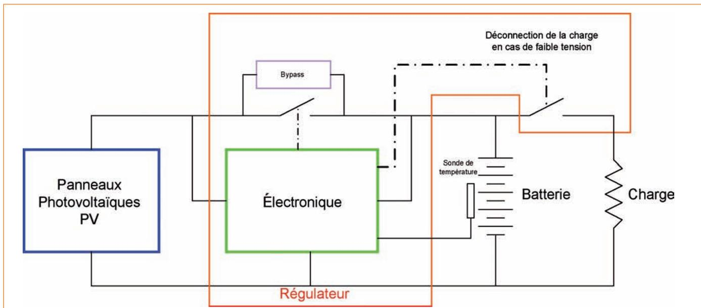
18 Le schéma de principe d'un régulateur
