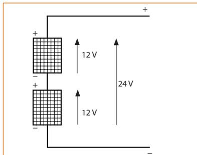
**28 Le raccordement de panneaux en série**
