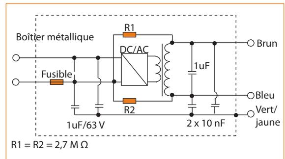
23 La structure interne d'un onduleur sinusoïdal
