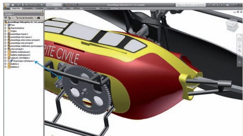
5 La fonction « engrenage » sur un modèle réduit d'hélicoptère
