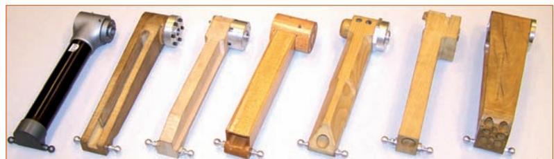
**8 Le bras initial en carbone et tous les prototypes réalisés (de gauche à droite : chêne, hêtre, hêtre, pin, chêne, chêne)**
