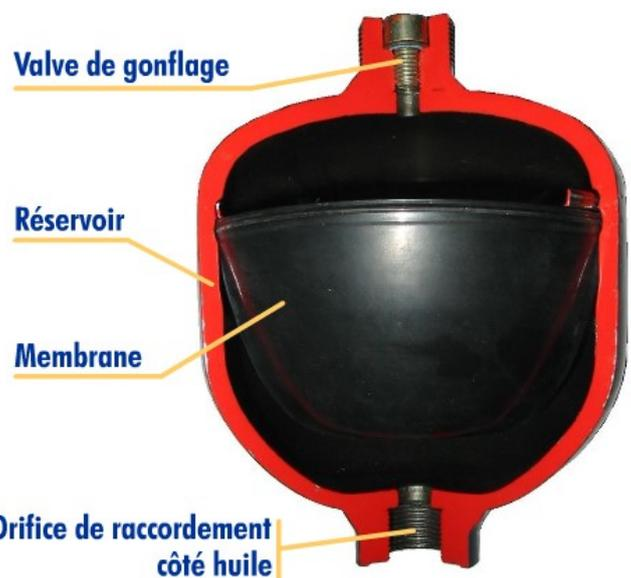
La membrane séparant le gaz du fluide est en élastomère, elle est constituée en son centre d'un renfort métallique (pastille) qui vient obturer l'orifice lorsque l'accumulateur est vidé de son huile, ce qui permet d'éviter l'extrusion de la membrane. Cette membrane doit être :
