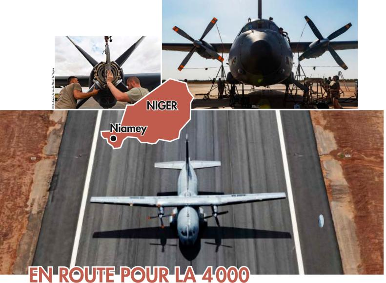
Un léger vent sec et chaud souffle sur le tarmac de la base opérationnelle projetée de Niamey, au Niger. Comme en apesanteur, le C160 Transall, immatriculé R211, repose sur de gigantesques vérins tripodes qui le maintiennent, train rentré, à un mètre du sol. Autour, les mécaniciens s'affairent pour cette opération délicate
