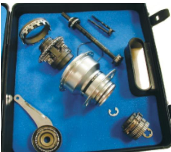
Figure 3. Le moyeu Nexus en partie démonté
