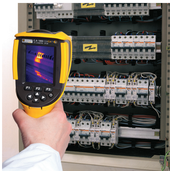
3 Contrôle de l'équilibre des phases dans un tableau de distribution électrique
