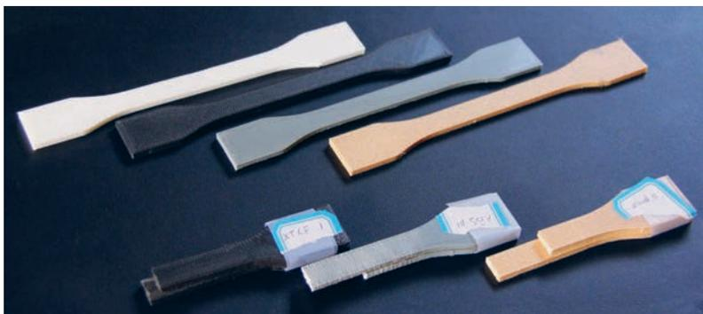
6 Éprouvettes avant et après rupture aux tests (traction longitudinale)
