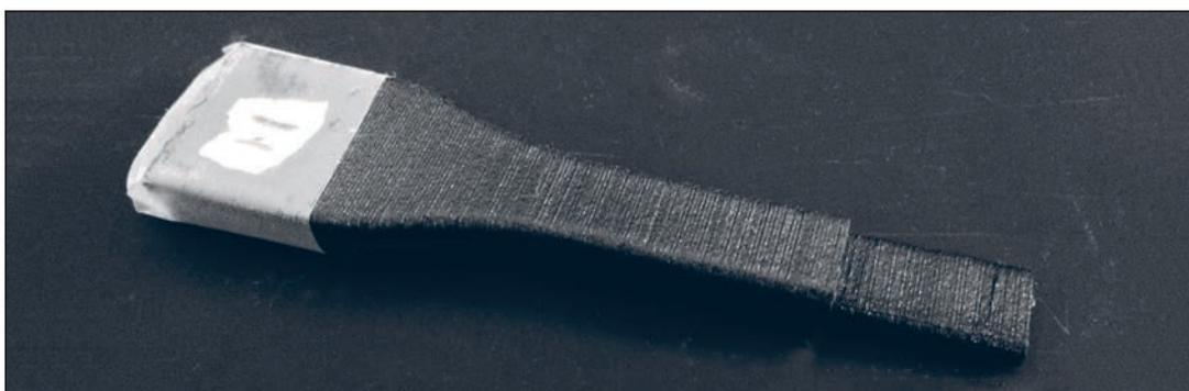
9 Éprouvette carbone après rupture aux tests (traction transversale)
