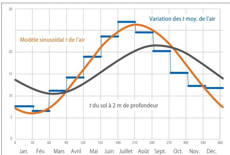
3 Variation de la température de l'air et du sous-sol à Marseille en 2015
