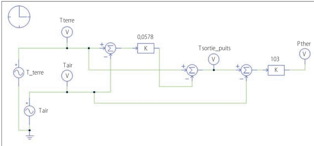
9 Simulation par schéma bloc sous Psim
