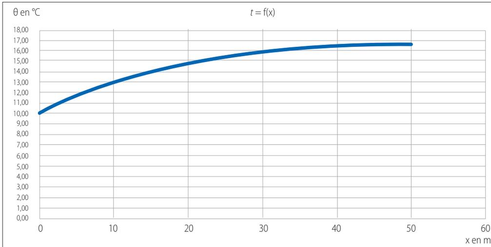
7 Variation de la température de l'air dans le puits
