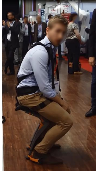
Figure 23. Dispositif d'assistance physique membres inférieurs (©INRS/ Gobio-Robot)
