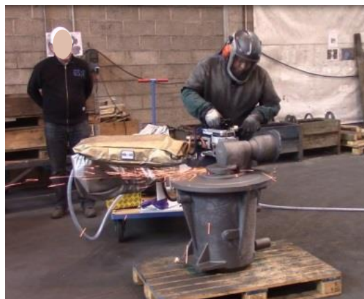
Figure 32. Essais de l'assistance au meulage (©INRS/PTP Industry/RB3D)
