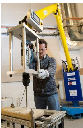
Figure 16. Manipulateur à compensation de masse de la société Sarrazin technologies. Crédit photo : Philippe Stroppa/CEA
