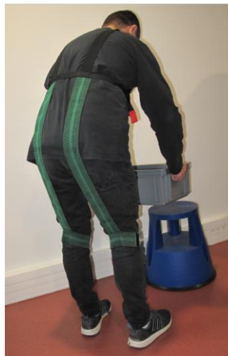
Figure 24. Dispositif de type harnais de force Corfor® (©INRS)
