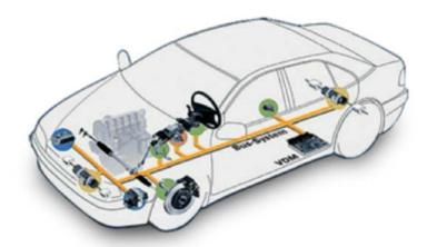
Le schéma ci-dessous montre une configuration possible de l'agencement des bus de terrain dans une voiture. Le bus CAN est séparé en deux groupes, l'un dédié au moteur et à la gestion des équipements de sécurité, l'autre aux équipements dit « de confort ». Le bus LIN est présent en tant que «sous-ensemble» du CAN. Le bus MOST gère, quant à lui, les systèmes audio et vidéo de la voiture.
