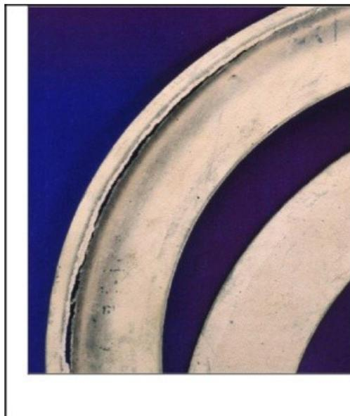
Figure 8 : Un joint fibre peut être découpé par portée la de bride
