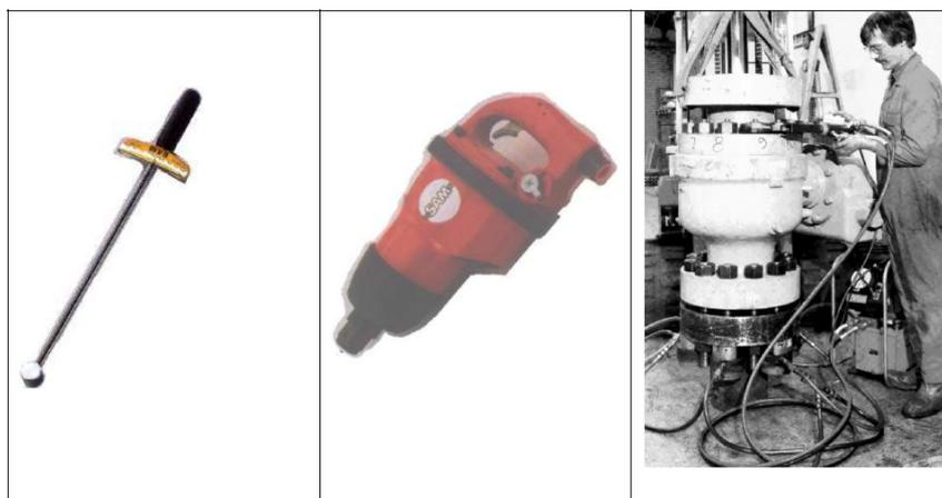
Le serrage manuel à la clé à main ou la clé à choc est en général limité à de la boulonnerie de 25mm de diamètre. Il en est de même pour l'utilisation de la clé dynamométrique.
