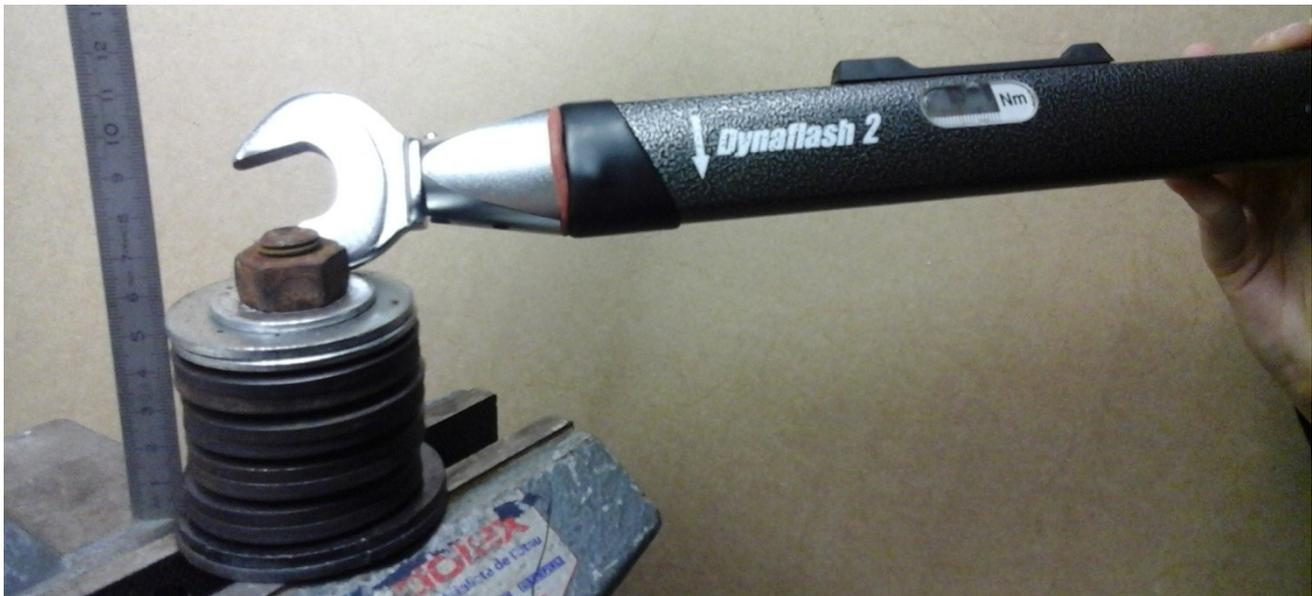
• Avec la clef dynamométrique étalonnée pour un couple donné, vous serrez l'ensemble jusqu'à déclenchement du couple, puis mesurez la hauteur de l'ensemble des rondelles. La variation de hauteur des rondelles ressort est proportionnelle à l'effort de serrage.
