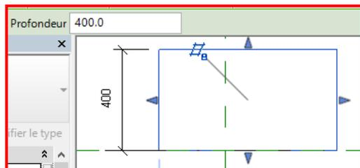
En élévation, j'en profite pour contrôler la « profondeur » de l'extrusion qui est la hauteur du gainable.
