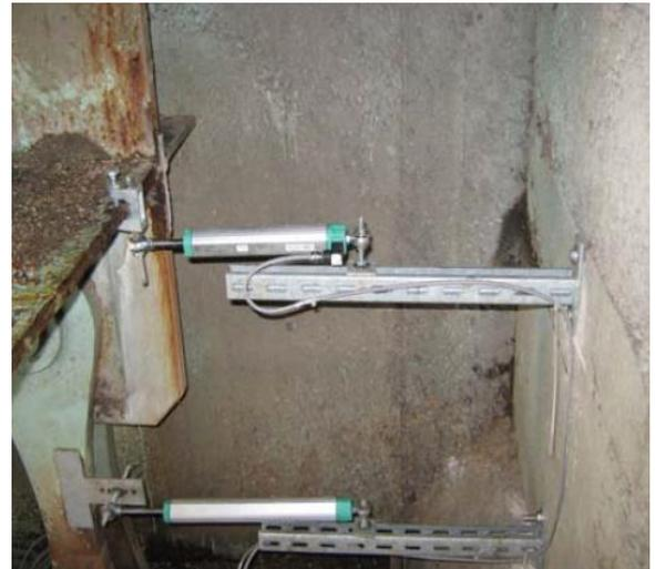
Figure 9 : Capteurs sur bielle et tablier
