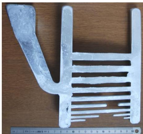
Figure 6 : Pièce en sortie de moule, défaut de mal venues sur les barreaux inférieurs
