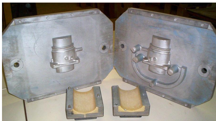
Figure 2 : Les plaques modèles et la boîte à noyau
