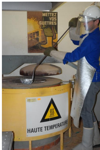
Figure 16 : Prélèvement de l'alliage liquide
