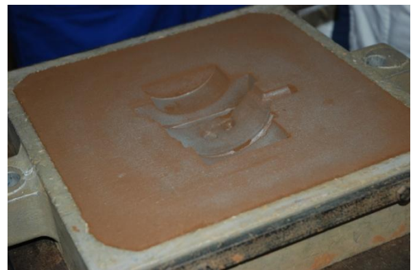
Figures 10 : Empreintes dans les châssis, la couleur argentée est un résidu de l'agent démoulant
