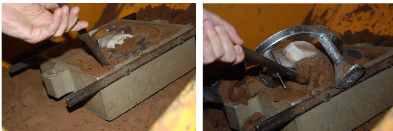
Figure 20 : Destruction du moule pour extraire la pièce brut de moulage et son noyau inclus
