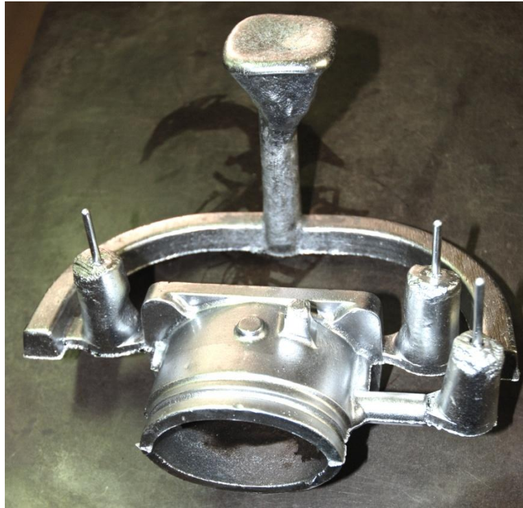
Figure 21 : La pièce brute de démoulage
