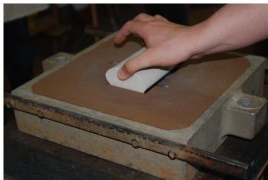
Figure 14 : Positionnement du noyau
