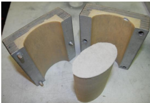
Figure 3 : Le noyau sorti de sa boîte
