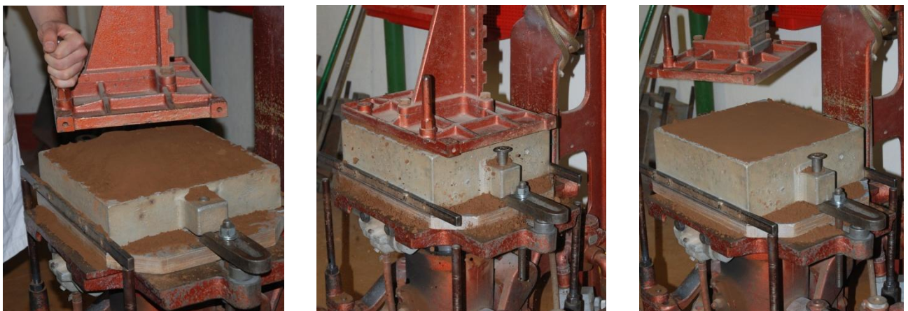
Figure 7 : Tassement mécanique du sable à vert dans le châssis
