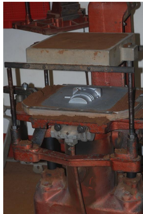
Figure 9 : Montée du châssis, libération des plaques modèle
