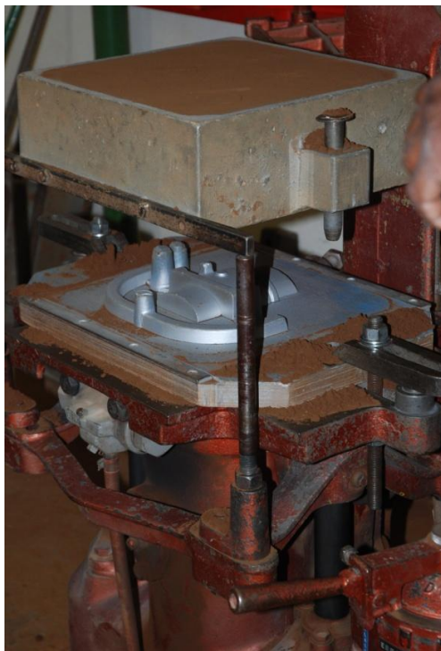
Figure 9 : Montée du châssis, libération des plaques modèle
