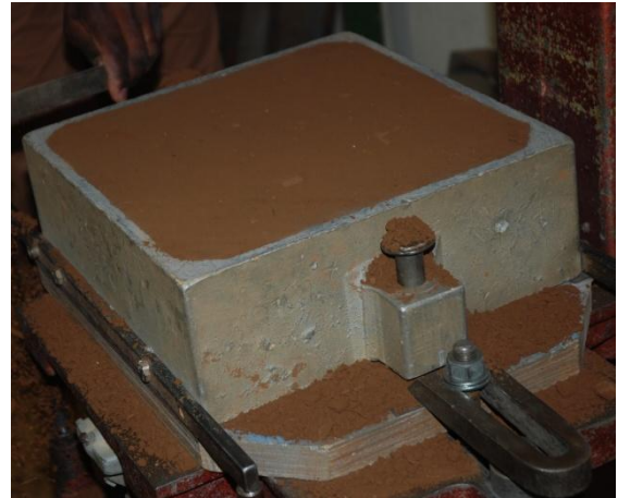
Figure 8 : Arasement du sable
