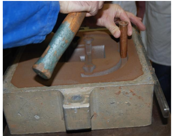
Figure 12 : Prolongation du trou de coulée
