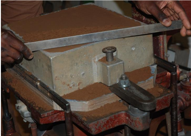
Figure 8 : Arasement du sable
