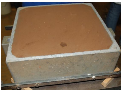
Figure 13 : Finition du trou de coulée
