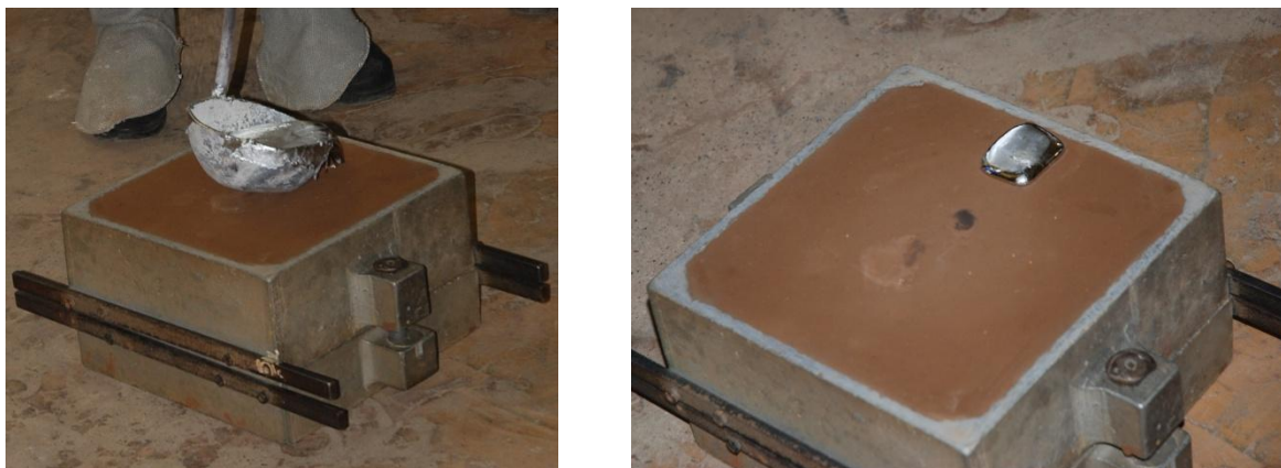
Figure 17 : Coulée et remplissage du moule
