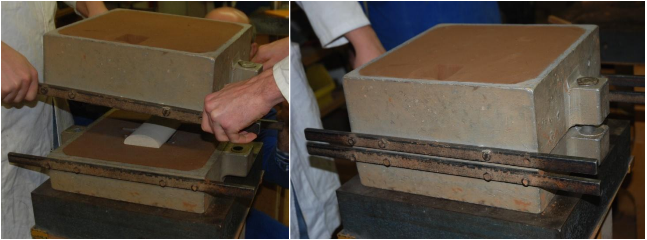
Figure 15 : Assemblage des deux châssis
