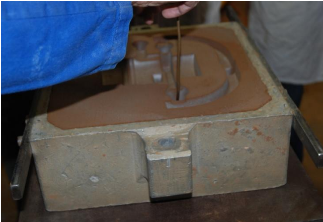
Figure 11 : Réalisation des événements à l'aiguille
