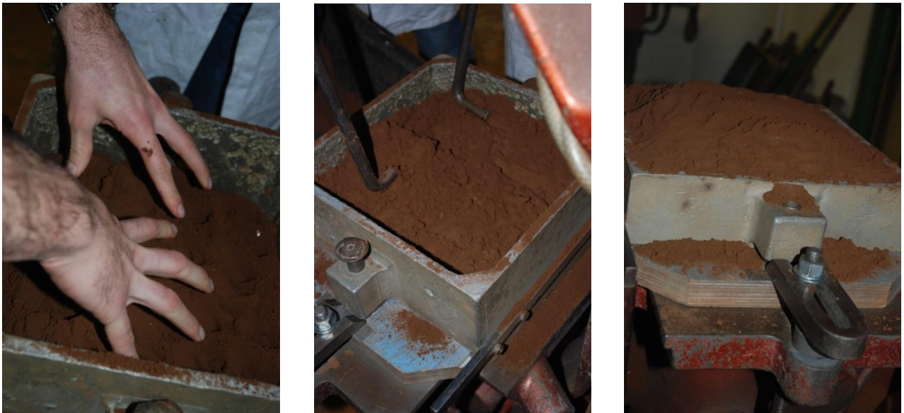
Figure 6 : Remplissage du châssis avec le sable à vert
