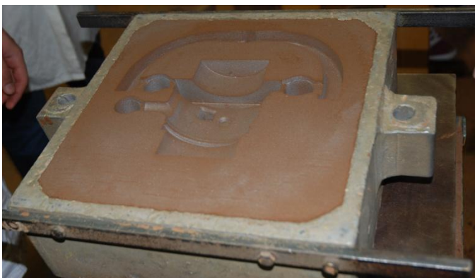
Figures 10 : Empreintes dans les châssis, la couleur argentée est un résidu de l'agent démoulant
