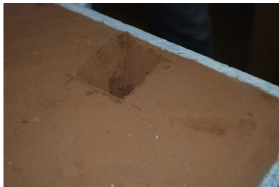
Figure 13 : Finition du trou de coulée
