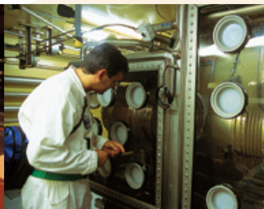
Four de calcination en boîte à gants.
