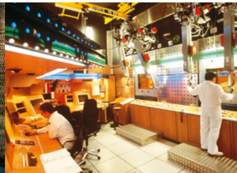
Salle de conduite de l'atelier de désentreposage.
