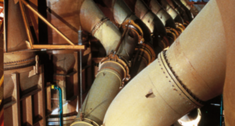
Enrichissement de l'uranium par diffusion gazeuse.
