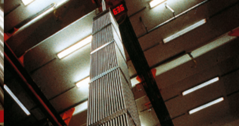
Assemblage de combustible MOX.
