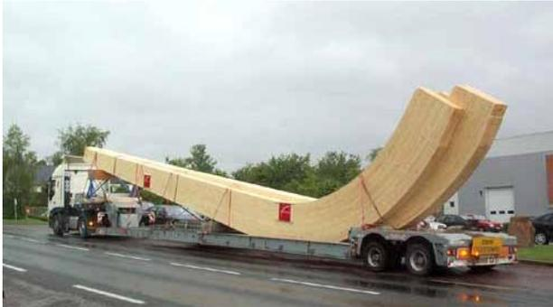
Figure 31 : Transport de charpente en bois lamellé-collé, image [21]
