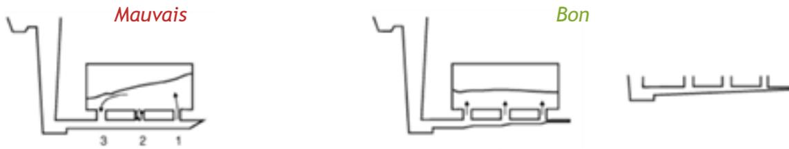
Figure 13 : Lors de multiples attaques d'une pièce il faut penser à réduire progressivement la section des canaux.
