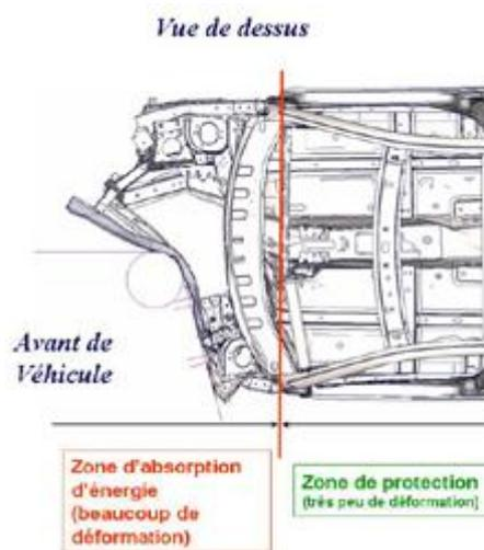
Figure 2 : Structure des caisses automobiles : distinction entre zone d'absorption et zone de détection
