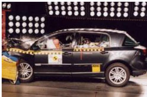
Figure 1 : Un véhicule en test de crash frontal
