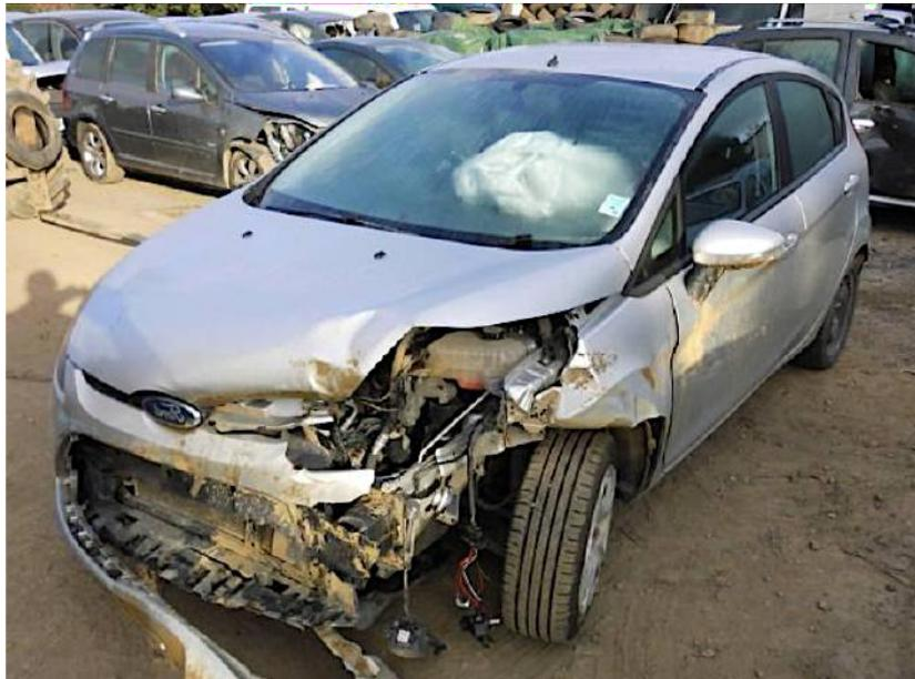
Le véhicule est non roulant, il est arrivé sur dépanneuse. Le longeron AVG laisse apparaitre d'importantes déformations et la roue AVG touche le passage de roue.
