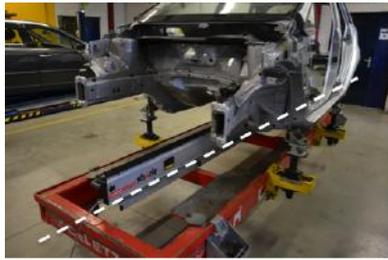
*Placer la poutre de mesure sous le véhicule, alignée avec son axe de symétrie.*
