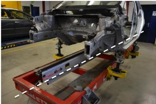
→ Placer la poutre sous l'axe de symétrie du véhicule
