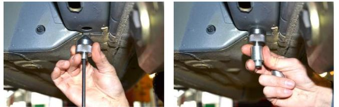
→ **Mettre en place la sonde**, en respectant l'orientation : étiquettes jaunes vers la poutre.
