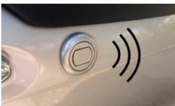
Les capteurs de stationnement logés dans les pare-chocs fonctionnent exactement sur le même principe que les sonars utilisés dans les forces militaires : émission et réflexion d'ultrasons contre un obstacle.
