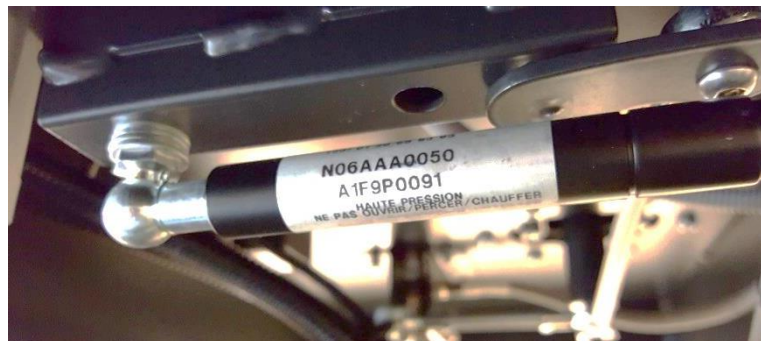
Figure 19 - Ressort à gaz du mécanisme à retour d'effort
