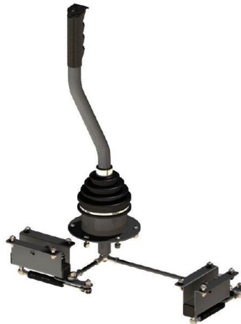
Figure 2 - Dispositif passif de retour d'effort du manche équipant le simulateur
